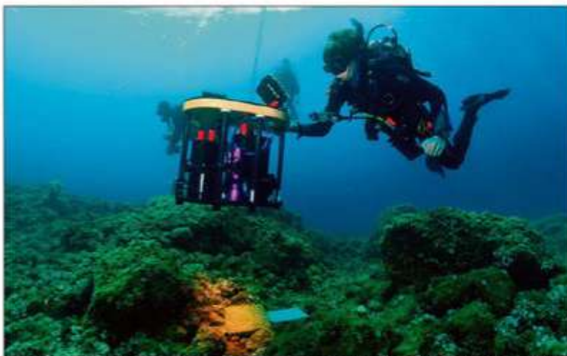
Parmi les outils utilisés pour ces recherches, cette caméra hyperspectrale permet de repérer et quantifier les espèces présentes. (Photo Patrice Francour)
