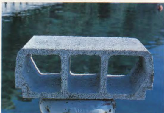
Élément en béton vibré (hourdi alvéolaire)
